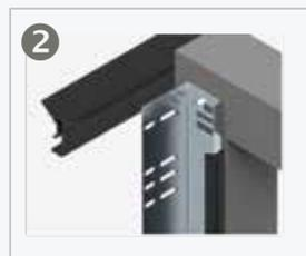
[2] 4D-Abdichtung: Das Schienensystem wird außenseitig dank einer 4-seitigen Abdichtung mit doppelter Lippe unsichtbar abgedeckt.
