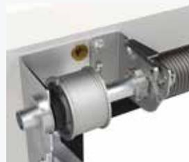
Die Bruchsicherung der Feder wird in den Haken eingehängt und am Klick-System angeschraubt. Die Feder selbst wird einfach eingeklinkt und nicht mehr an die Bruchsicherung angeschraubt.
