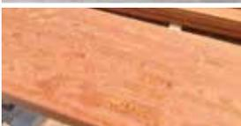
**Widerspanigkeit:** Diese rauen Stellen sind keine Hobelfehler. Bei Wechseldrehwuchs und im Astbereich ist diese raue Holzstruktur auch mit bestem Hobelwerkzeug nicht zu vermeiden.
